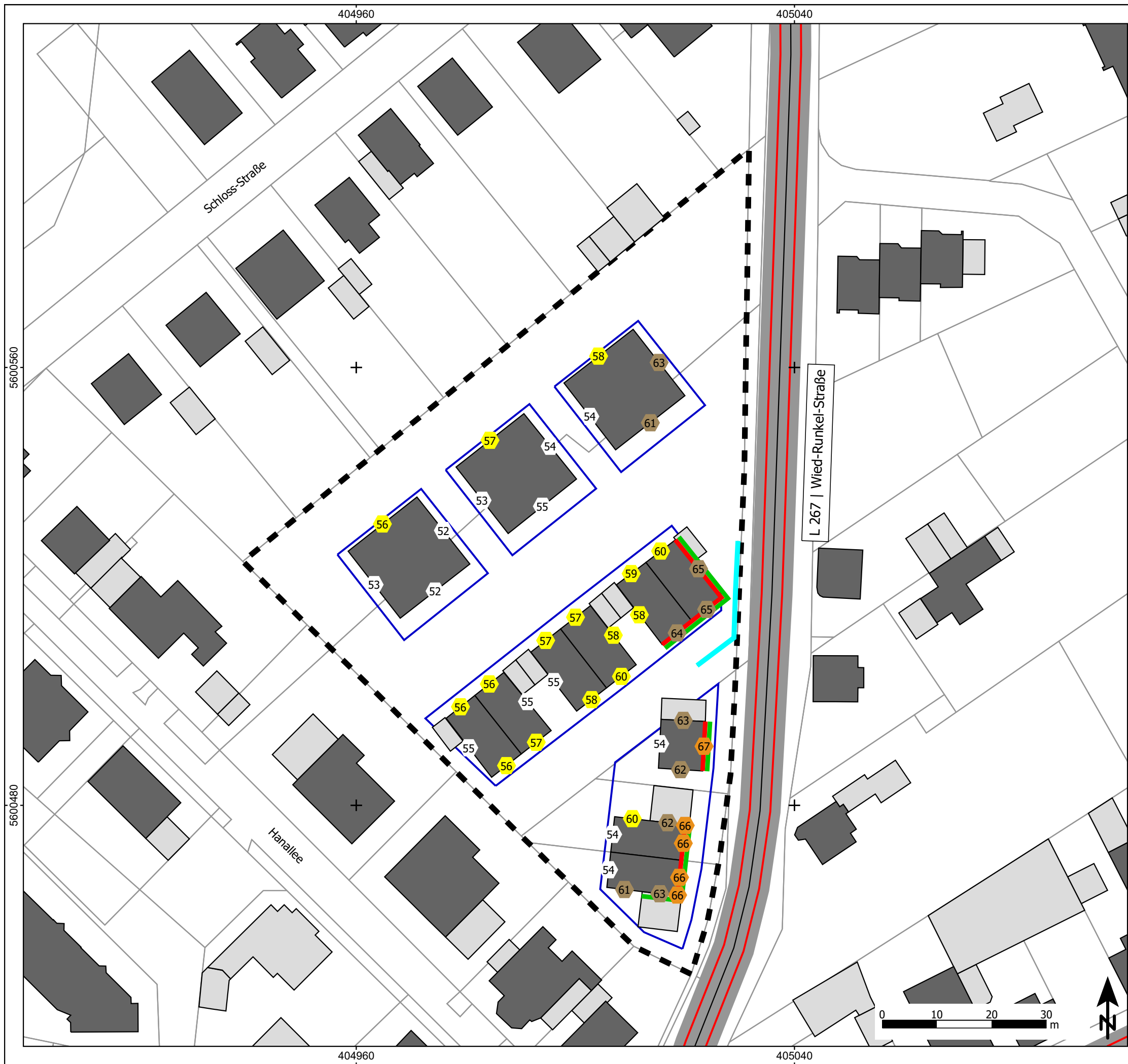
Abbildung A11 Schallschutzkonzept Verkehrslärm Städtebauliches Konzept Höchster Pegel an der Fassade
