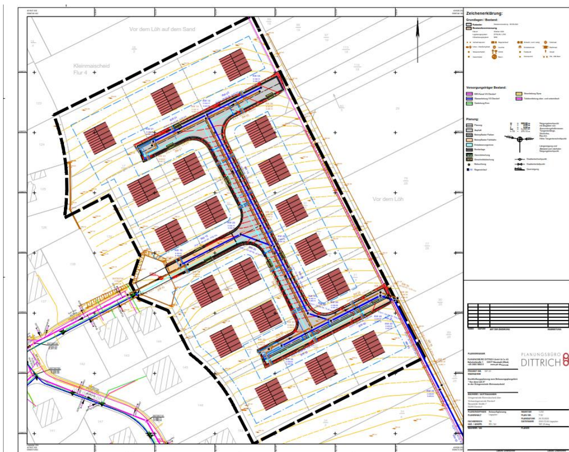
Abb. 13: Entwässerung: Lageplan vom Baugebiet (Planungsbüro Dittrich)
